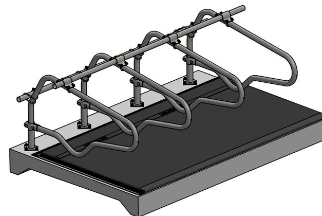
**Achtung: Montieren Sie den Gummistreifen mit einem Abstand von 10 cm zum Seitenende der Liegeboxreihe. Dieses ist zwingend notwendig, um später das Seitenprofil befestigen zu können.**
